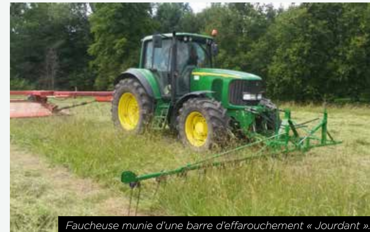
Faucheuse munie d'une barre d'effarouchement « Jourdan ».
