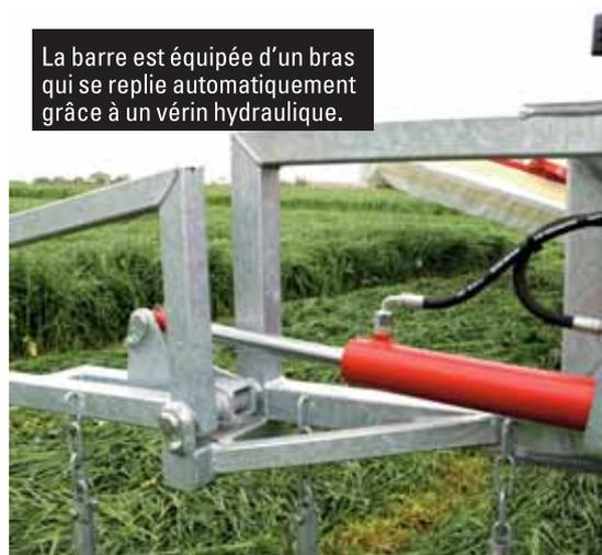
La barre est équipée d'un bras qui se replie automatiquement grâce à un vérin hydraulique.
