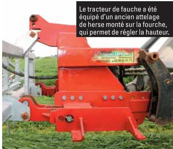
Le tracteur de fauche a été équipé d'un ancien attelage de herse monté sur la fourche, qui permet de régler la hauteur.
